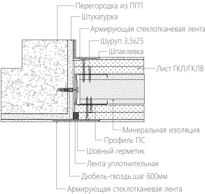
Узел стыка ГКЛ и ПГП перегородок
